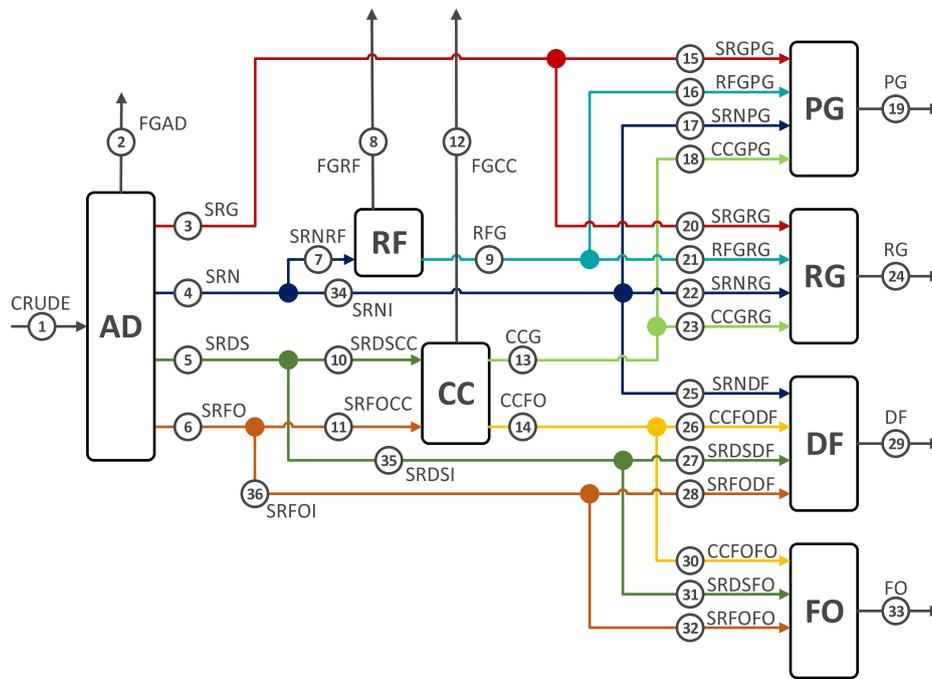
Fig. 1. Refinery scheme.
